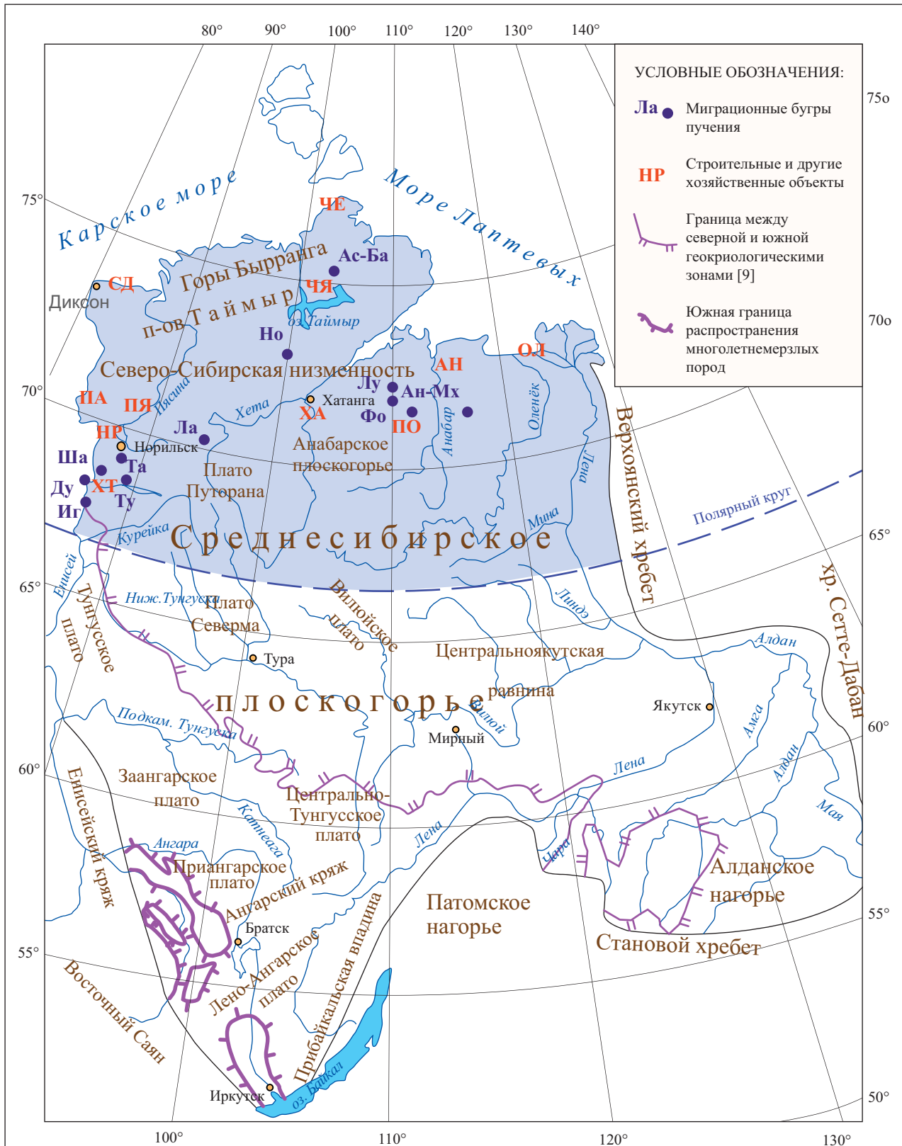
Рис. 1. Карта-схема распространения миграционных бугров пучения и объектов строительства и другой хозяйственной деятельности в заполярных районах криолитозоны Средней Сибири. Массивы многолетнемерзлых миграционных торфяных бугров: Ан-Мх — долины рек Анабар, Оленек, Котуй, Попигай, Марха; Ас-Ба — пальза на озерах Астрономическое, Белое, Барометрическое; Ду — Дудинка; Иг — Игарка; Ла — оз. Лама; Лу — Лукунский лес; Но — р. Новая (Ары-Мас); Та — р. Талнах; Ту — р. Турумакита; Фо — р. Фомич; Ша — севернее мыса Шайтанский. Инженерно-геологические объекты: АН — Анабарское россыпное алмазное месторождение; НР — Норильский горнодобывающий узел (Талнахско-Октябрьское месторождение); ПА — Паяхское нефтяное месторождение; ПО — Попигайское месторождение импактных алмазов; ПЯ — Пясинское угольное месторождение; СД — Сырдасайское угольное месторождение; ХА — Хатангское месторождение бурых углей (нефтяные залежи: Нордвикская, Ильинская и Кожевниковская); ОЛ — Оленекское месторождение природных битумов; ХТ — Хантайская и Усть-Хантайская ГЭС, ЧЕ — Челюскинское золотоносное месторождение; ЧЯ — Черноярское угольное месторождение
