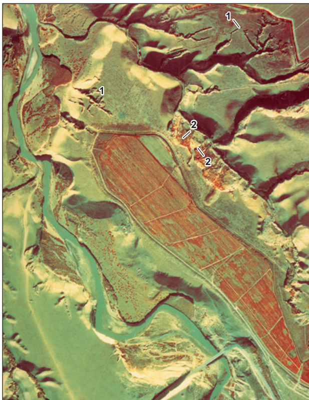
Рис. 6. Фрагмент многозонального аэроснимка предгорий хребта Каратау в Таджикистане. Оползни в лессовидных суглинистых толщах: 1 — начальные стадии оползней, формирование трещин-заколов, в ряде случаев обработанных овражной эрозией; 2 — сформировавшиеся оползневые цирки со сложной структурой сместившихся масс (головная часть — блоки, центральная — поперечные гряды, языковая — натечная структура)
