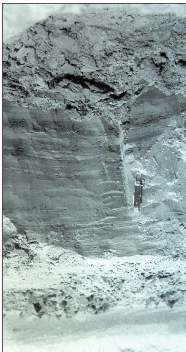
Рис. 9. Изменения по глубине слоистости намывных грунтов — хвостов обогащения Лебединского ГОК (фото Е.А. Лычагина)
