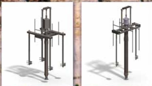
Общий вид штампов с максимальным давлением на грунт 15 кгс/см<sup>2</sup> и 6 кгс/см<sup>2</sup>
