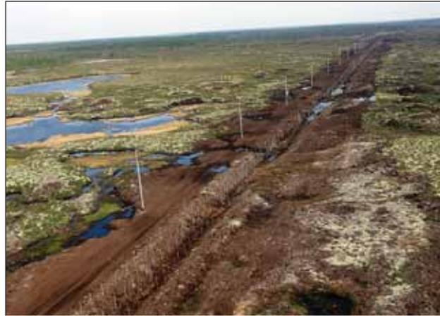
**Рис. 8. Проявления термокарста вдоль трассы «горячего» нефтепровода. Термокарстовые воронки, отмеченные на месте протаявших бугров пучения, маркируют боковую границу ореола протаивания вдоль трассы (лесотундровая зона Западной Сибири, Пур-Тазовское междуречье близ реки Айваседа-Пур) (фото из архива ОАО «ВНИИСТ»)**
