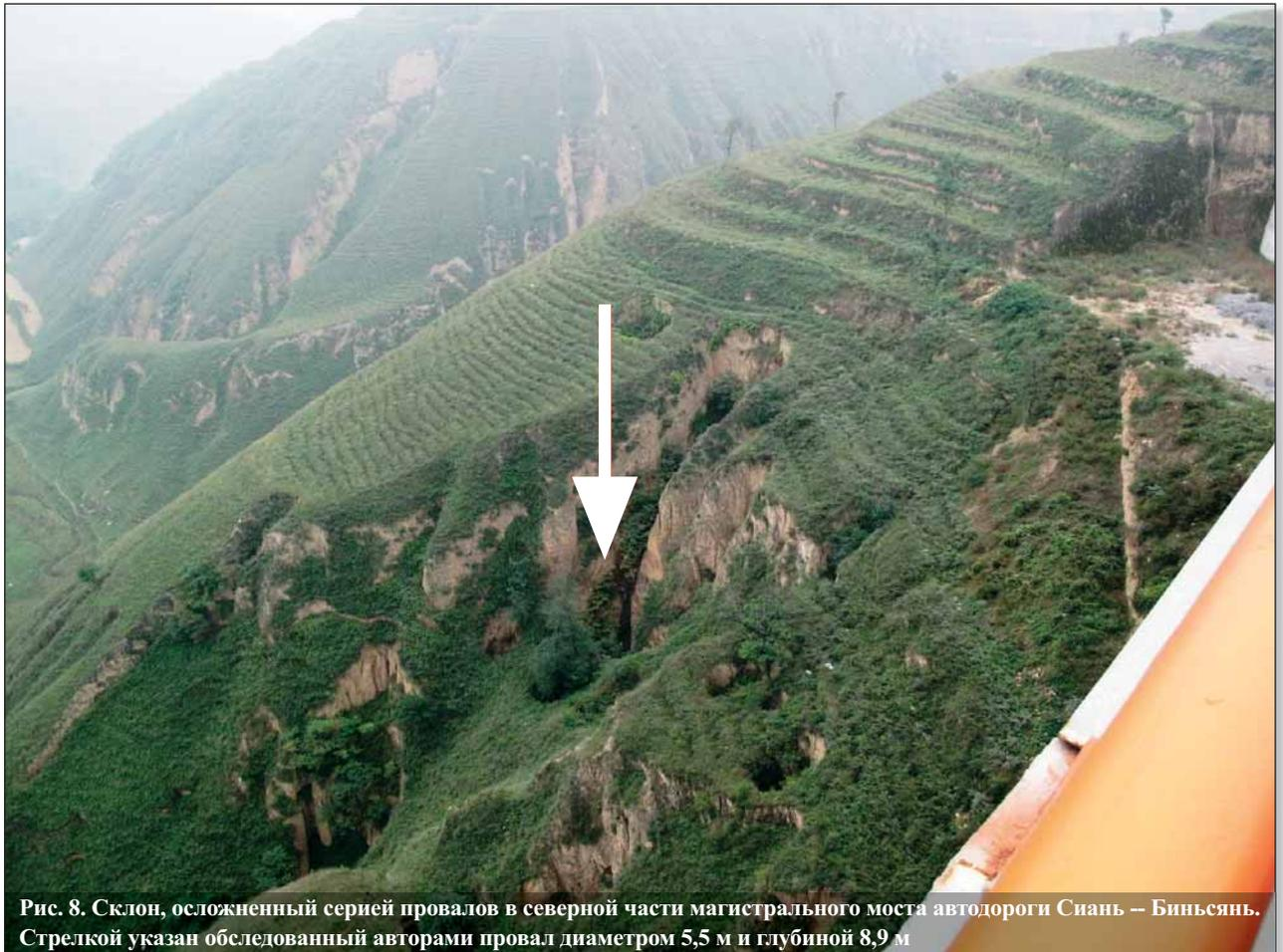
Рис. 8. Склон, осложненный серией провалов в северной части магистрального моста автодороги Сиань – Биньсянь. Стрелкой указан обследованный авторами провал диаметром 5,5 м и глубиной 8,9 м
