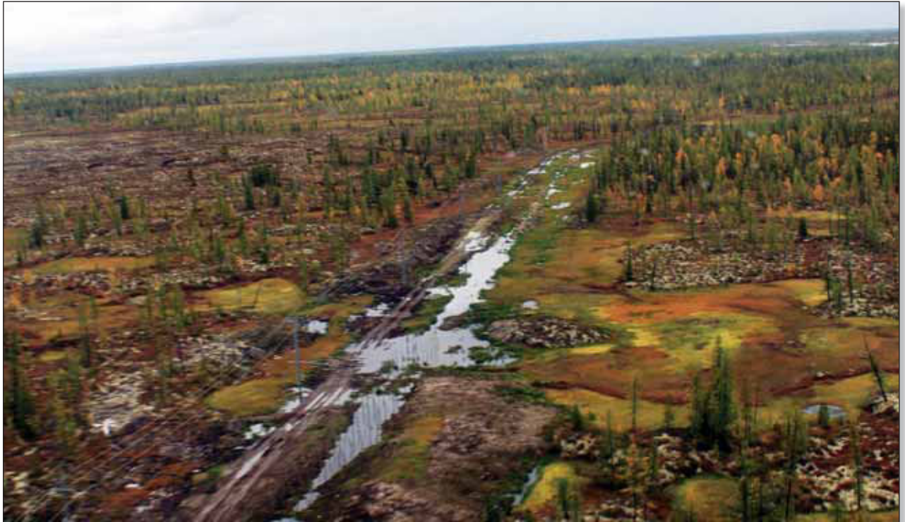
Рис. 6. Подтопление трассы «горячего» трубопровода при прохождении массива многолетнемерзлых выпуклых бугров пучения в лесотундровой зоне Западной Сибири (Пур-Тазовское междуречье, близ р. Айваседа-Пур). Вдоль трассы наблюдаются как непротаявшие, так и протаявшие бугры (фото из архива ОАО «ВНИИСТ»)
