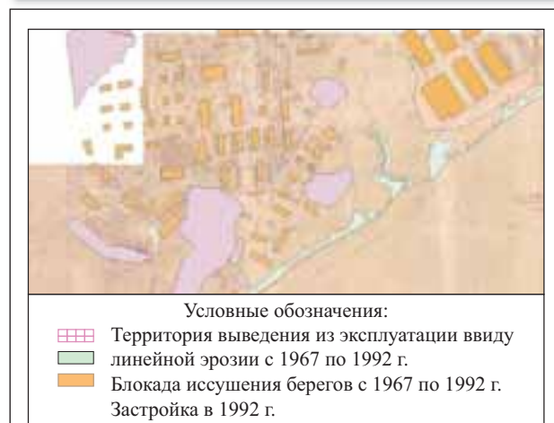
Рис. 5. Разрушение земельного фонда в с. Лорино в результате действия эрозионных процессов 1967–1992 гг.
