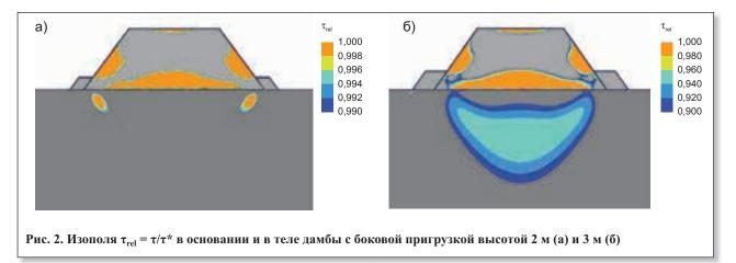
солидационный процесс. Время стабилизации НДС основания в этом случае в значительной мере зависит от коэффициентов фильтрации  $k_f$  и консолидации  $C_v$  грунтов основания, его толщины h и граничных условий [2, 3].
