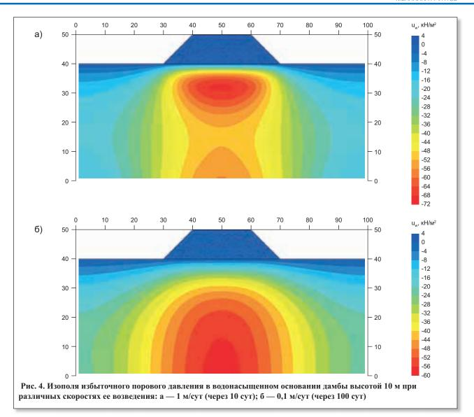
с точки зрения их устойчивости является начальный период возведения дамбы (важна также скорость ее возведения в этот период времени). Поэтому при строительстве таких сооружений на слабых водонасыщенных основаниях следует контролировать (дистанционно измерять с использованием специальных датчиков) уровень избыточного порового давления и соответствующим образом регулировать темп их возведения.
