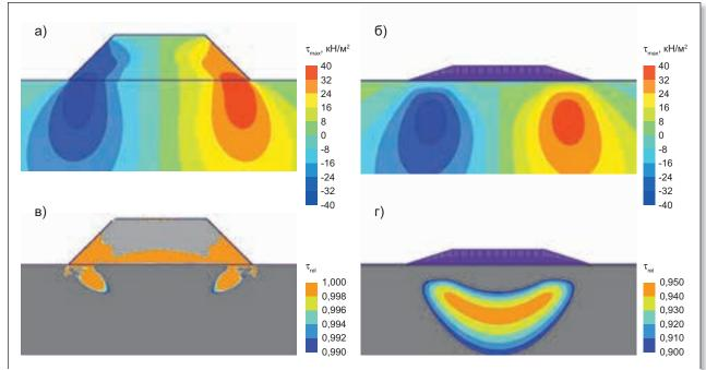
Рис. 1. Изополя  $\tau_{max}$  и  $\tau_{rel}$  в основании и в теле дамбы с учетом (a, в) и без учета (б, г) жесткости дамбы (рисунки снизу и по бокам срезаны)
