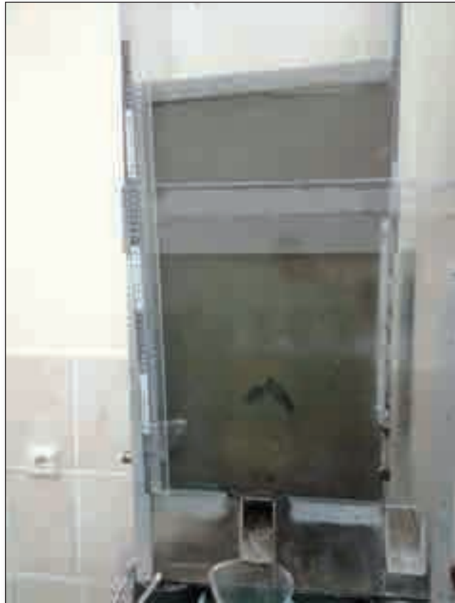
Рис. 5. Установка для моделирования провалообразования (конструкция Д.М. Димухаметова, ПГНИУ)
