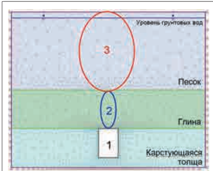
Рис. 4. Конечно-элементная модель двухслойной покровной толщи грунтов над карстовой полостью: 1 — карстовая полость некритической ширины; 2 — зона возможного развития вывала глинистых грунтов в карстовую полость, в результате которого вероятно образование вторичной карстовой полости; 3 — зона развития в песчаной толще деформаций, сопровождающихся формированием вторичных полостей и общим разрыхлением песков
