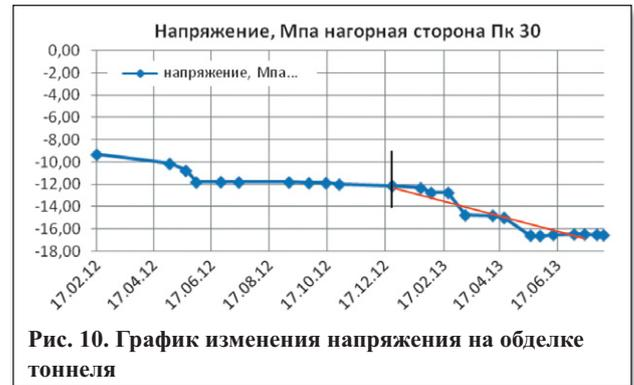
Рис. 10. График изменения напряжения на обделке тоннеля
