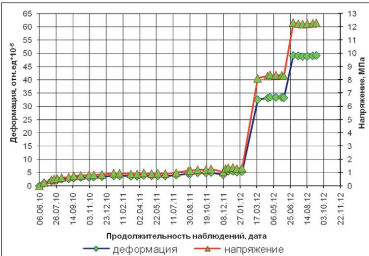
Рис. 3. Динамика изменения НДС обделки тоннеля (оползневый склон, поселок Хоста г. Сочи)
