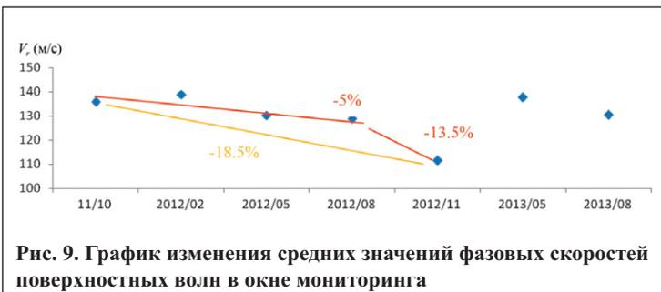
Рис. 9. График изменения средних значений фазовых скоростей поверхностных волн в окне мониторинга
