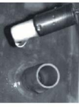
Рис. 6. Пробники для локального измерения порового давления в грунтах: а — для мягких нормально уплотненных грунтов; б — для переуплотненных грунтов с возможностью принудительного насыщения пробника (по [7])
