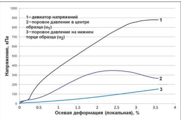
Рис. 8. Недренированное кинематическое трехосное сжатие глины с боковыми дренами. Образец 100×200 мм, скорость деформации 5% в сутки
