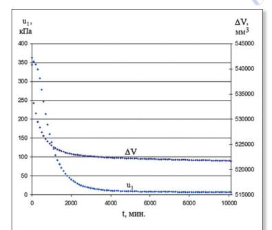
Рис. 10. Консолидация плотной глины:  $u_1$  — поровое давление;  $\Delta V$  — изменение объёма образца, t — время
