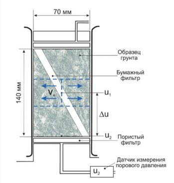
Рис. 5. Схема к расчету времени радиальной миграции влаги в образце в условиях трехосного сжатия (пояснения в тексте)
