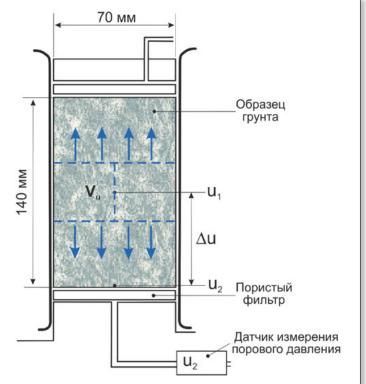
Рис. 4. Схема к расчету времени вертикальной миграции влаги в образце в условиях трехосного сжатия (пояснения в тексте)
