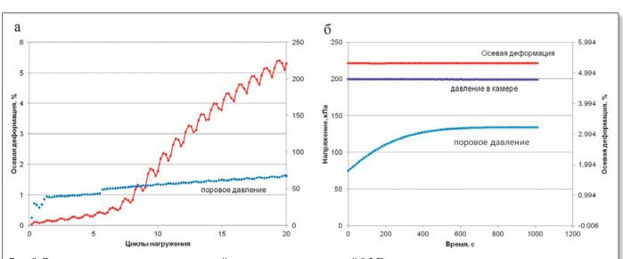
Рис. 9. Результаты динамических испытаний плотного песка с частотой 0,2 Гц при параметре порового давления Скемптона B=0,96: а — динамическое нагружение, б — после прекращения динамического воздействия
