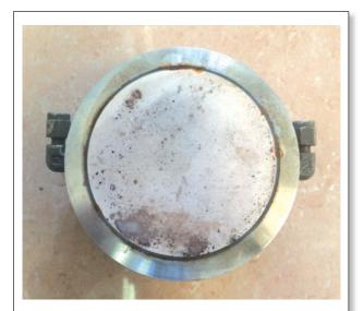
Рис. 2. Пьедестал камеры трехосного сжатия с вмонтированным керамическим фильтром для обеспечения заданного давления входа воздуха (high air entry porous stone)
