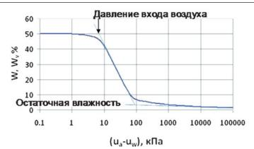
Рис. 1. Характеристическая кривая связного грунта. W — влажность;  $W_v$  — объемная влажность;  $(u_a - u_w)$  — капиллярное всасывание, равное разнице между давлением в газовой и водной фазах соответственно
