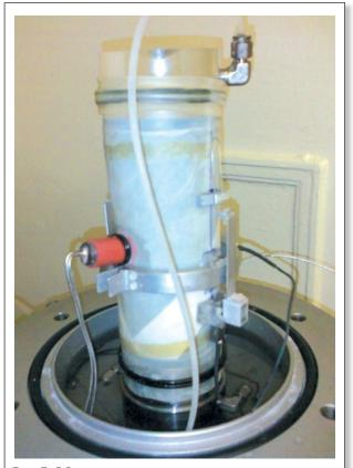
Рис. 7. Образец глинистого грунта с установленными датчиками локального измерения порового давления и деформаций
