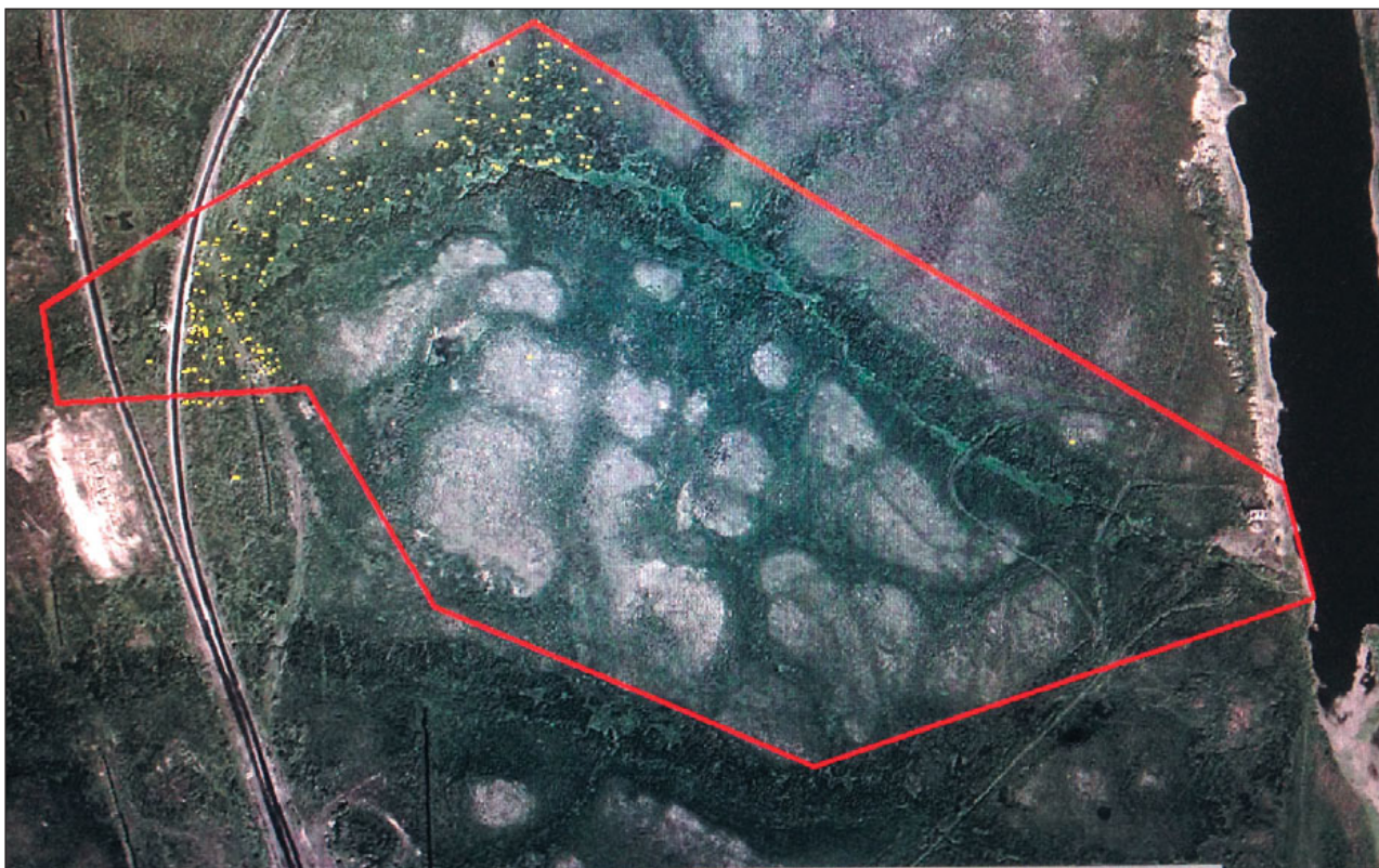
Рис. 23. Бугры пучения (пальза и литальза) в пределах учебно-научного полигона в районе станции Хановой. Красным цветом выделены границы полигона. Желтые точки — участки геодезической съемки
