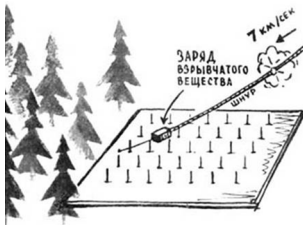
Эксперименты, моделирующие Тунгусскую катастрофу: слева – схема модельного опыта М.А. Цикулина; в центре и справа – схема и результат опытов И.Т. Зоткина и М.А. Цикулина (1965 г.)
