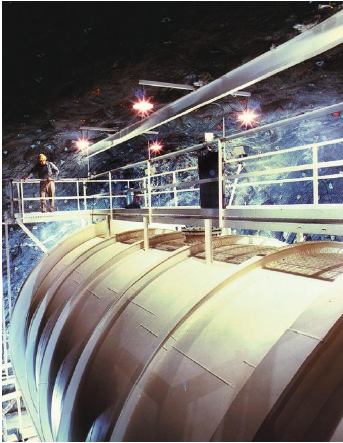
Резервуар с 380-ю тысячами литров жидкой мишени (перхлорэтилен C_2Cl_4 ) для детектирования солнечных нейтрино в ходе хлор-аргонового эксперимента, проведенного Р. Дэвисом в шахте Хоумстейк (США). Рисунок воспроизводится с разрешения Brookhaven National Laboratory.
