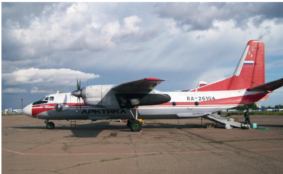
Самолет лаборатория AN-26БРЛ. На нем находились гравиметры типа “Силомер” российского производства; остальная аппаратура изготовлена в ИФЗ РАН.
