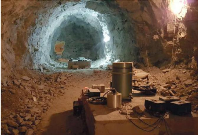
*Лаборатория на отметке 3,9 км в штольне Баксанской нейтринной обсерватории РАН в Баксанском ущелье. Измерительные постаменты с установленными геофизическими информационно-измерительными комплексами; это такие приборы как сейсмометры различных типов, кварцевые наклонометры и гравиметр конструкции доктора технических наук Д.Г. Гриднева; магнитные вариометры, температурные станции и вспомогательное оборудование. Северо-Кавказская геофизическая обсерватория. Фото С.М. Долова.*
