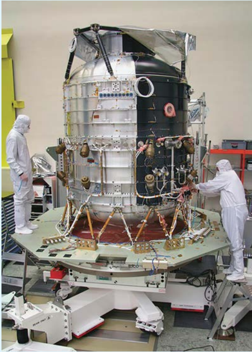
Криостат с охлажденным до температуры 2,7 К гелием, установленный на космической обсерватории "Спитцер". Фото NASA/JPL.
