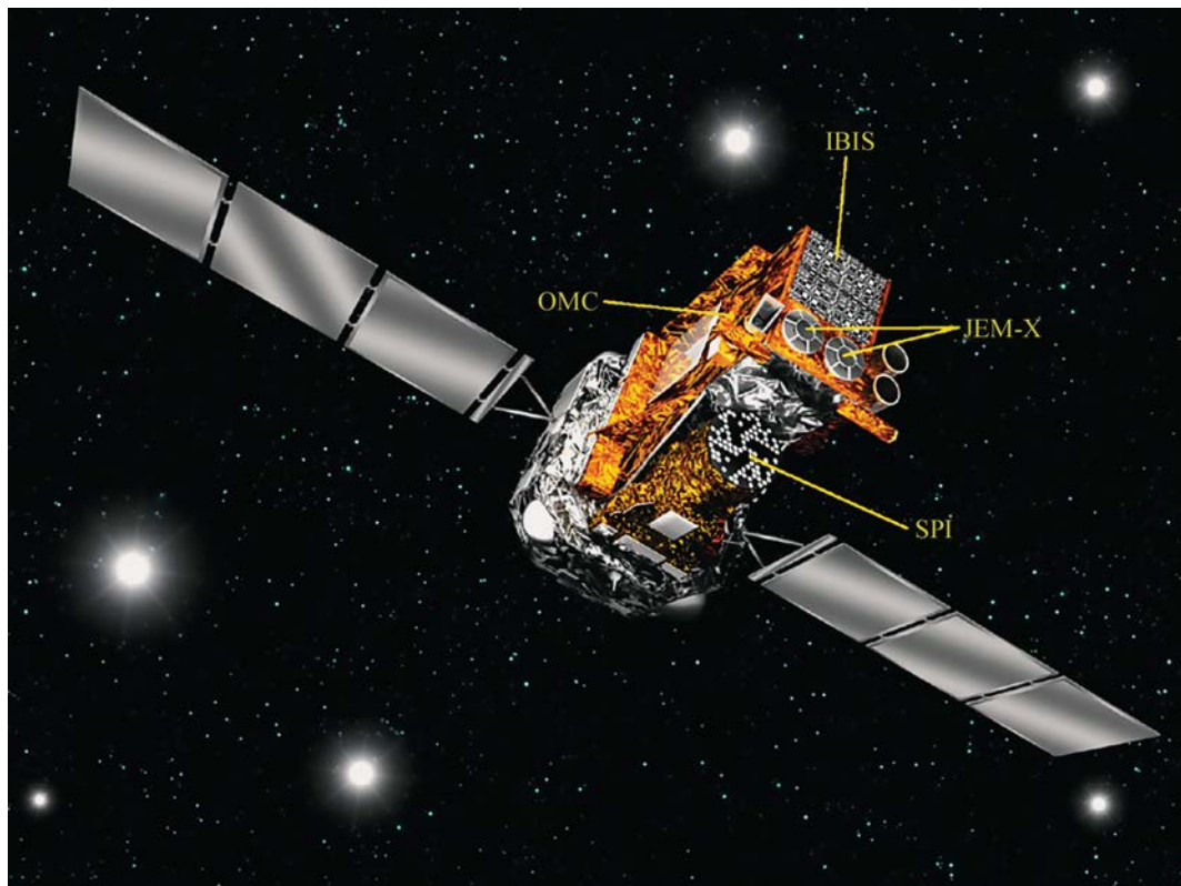
Космическая обсерватория "Интеграл": основные детекторы излучения: IBIS – гамма-телескоп, SPI – рентгеновский спектрометр, JEM-X – рентгеновский монитор для получения изображения неба, OMC – оптический монитор для получения изображения неба в оптических лучах. Рисунок ESA.
