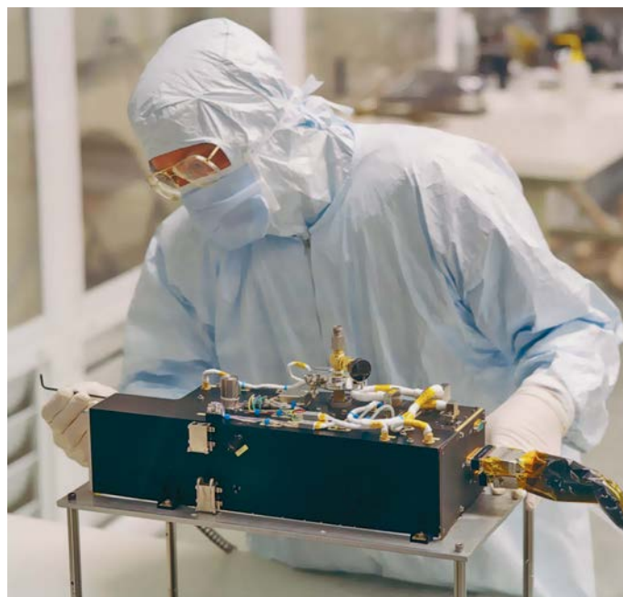
Сборка спектрографа ALICE. Фото ESA.
