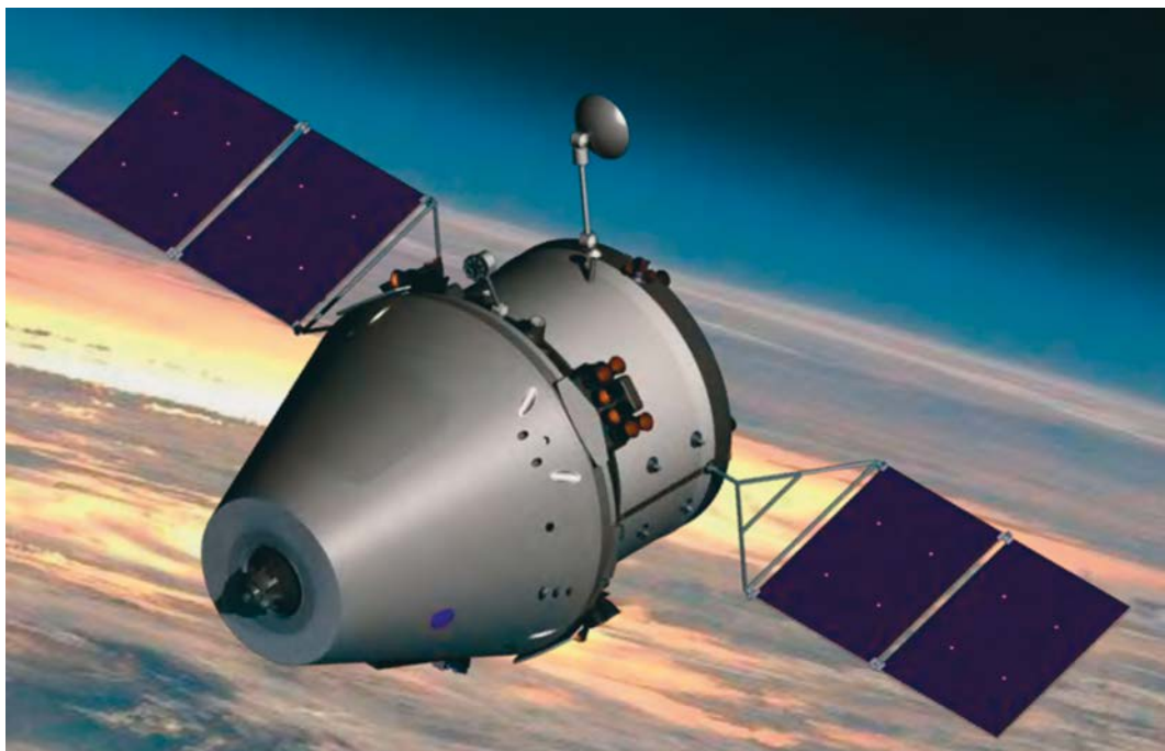
Российский перспективный многоразовый пилотируемый корабль “Федерация” (длина 6 м, диаметр 4,4 м, масса 12–16,5 т, экипаж 4–6 человек). Первый беспилотный запуск запланирован на 2022 г. Рисунок РКК “Энергия” им. С.П. Королёва.
