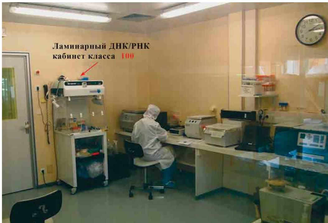
*“Чистое” лабораторное помещение класса “10 тысяч”, в котором проводились работы по молекулярно-микробиологическому анализу образцов замерзшей воды подледникового озера Восток. Фото автора.*
