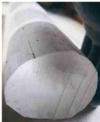
Сегмент керна льда с образцом замерзшей воды "borehole-frozen"; получен с глубины 3429 м. В нем обнаружена бета-протеобактерия с 93% сходства с *Janthinobacterium sp.* (из семейства *Oxalobacteriaceae*). На просвет лед непрозрачный, имеет "молочный" оттенок из-за присутствия многочисленных микрокапель керосина. Фото автора.
