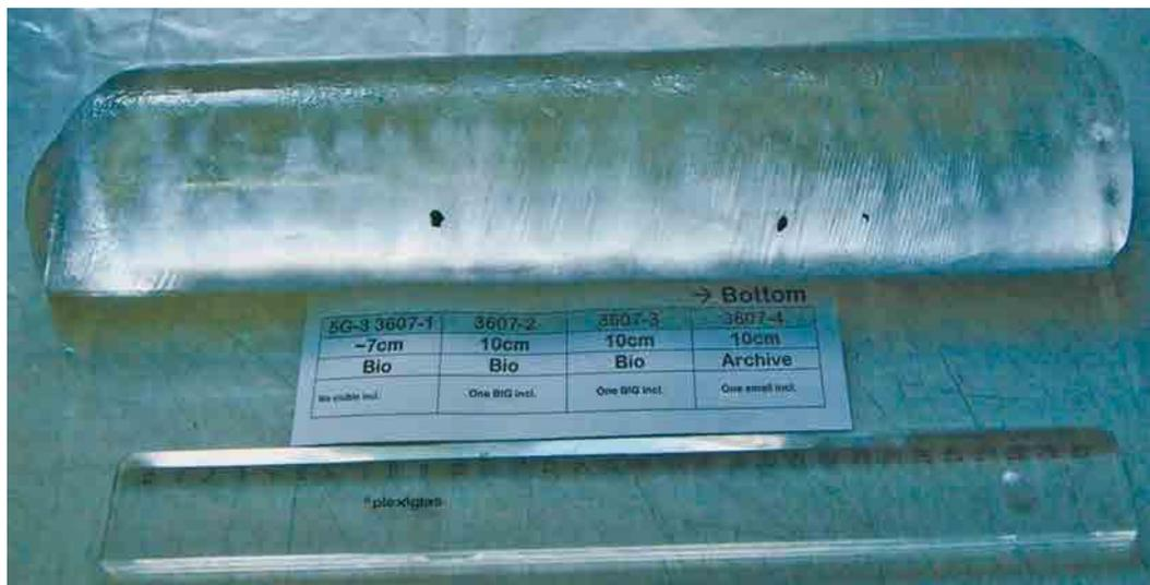
*Образец природного озерного льда первого типа, полученного с глубины 3607 м. Отчетливо видны три минеральных включения, находящиеся в матрице монокристаллического льда. Фото автора.*
