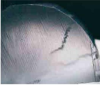
*Сегмент керна льда с образцом замерзшей воды “clean borehole-frozen”; получен с глубины 3709 м. Отчетливо видны немногочисленные извилистые каналы, выходящие на поверхность сегмента льда (керна): они заполнены буровой жидкостью. Фото автора.*
