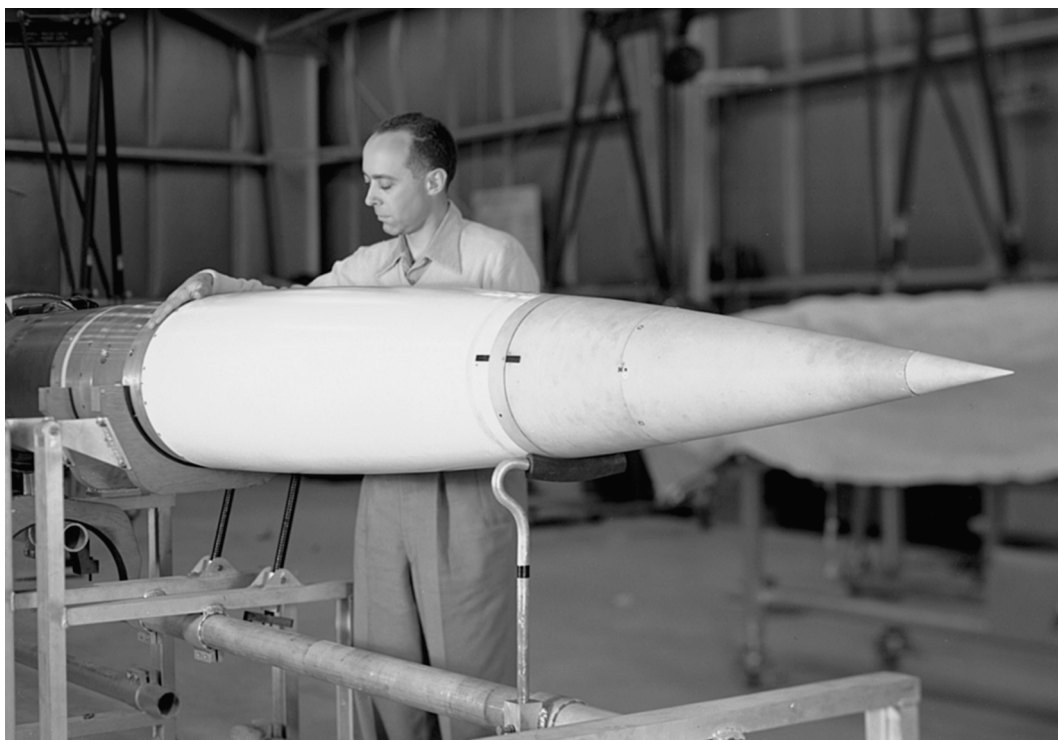
Сборка американской неуправляемой суборбитальной зондирующей ракеты “Аэробе-150” (“Aerobee”). В 1950-х гг. она применялась для высотного исследования атмосферного и космического излучения.
