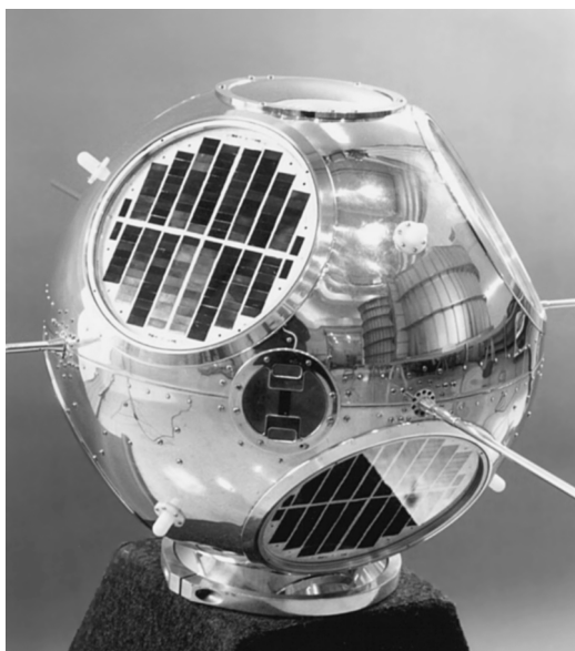
ИСЗ “Солрад” (“Solrad-1”) для исследования солнечного рентгеновского излучения, запущен 22 июня 1960 г. В 1960–1976 гг. запущено 16 спутников этой серии, из них 12 – успешно. Фото NASA.
