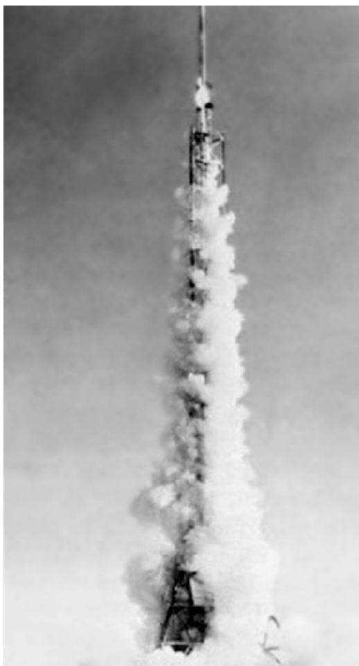
Запуск геофизической ракеты "Aerobee USAF-9" с ракетного полигона Уайт Сэндс. Максимальная высота подъема ракеты составила 108,2 км. 1950 г.
