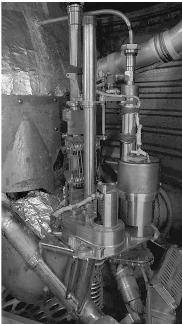
Грунтозаборный механизм с буром на посадочном аппарате АМС "Вега". Музей НПО им. С.А. Лавочкина.
