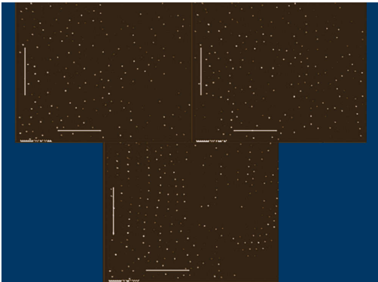
Видеоизображения, полученные камерой большого увеличения в эксперименте по структурному фазовому переходу (давление аргона – 10 Па, частицы диаметром 6,8 мкм, частота внешнего поля – 100 Гц, концентрация пылевой компоненты – 3 \times 10^4 \text{ см}^{-3} , температура ионов – 0,03 эВ). В плазменно-пылевой системе увеличивается упорядоченность, формируется цепочечная структура.
