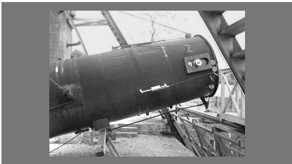
Современная копия трубы телескопа В. Парсонса "Левиафан". Зеркало – алюминий (вес – 1 т), труба – дубовый тес. Восстановлен Лоренсом Майклом, шестым графом Россом, с участием общественных и благотворительных организаций. 1990-е гг.
