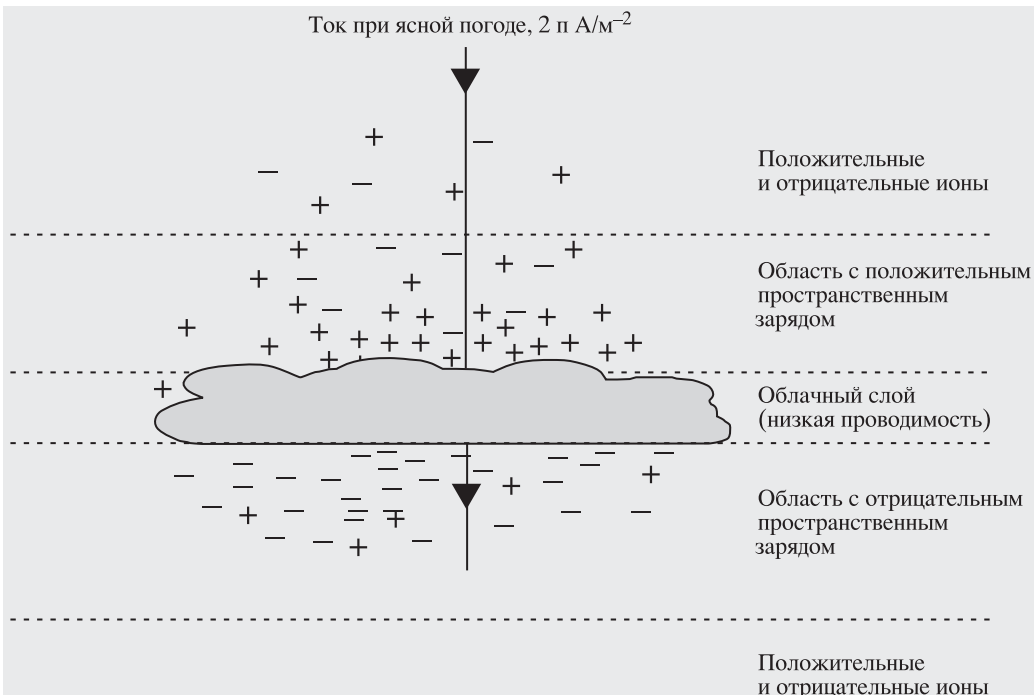
Схема работы глобальной электрической сети при ясной погоде и в тропосферном облаке. По данным Р. Харрисона с коллегами.
