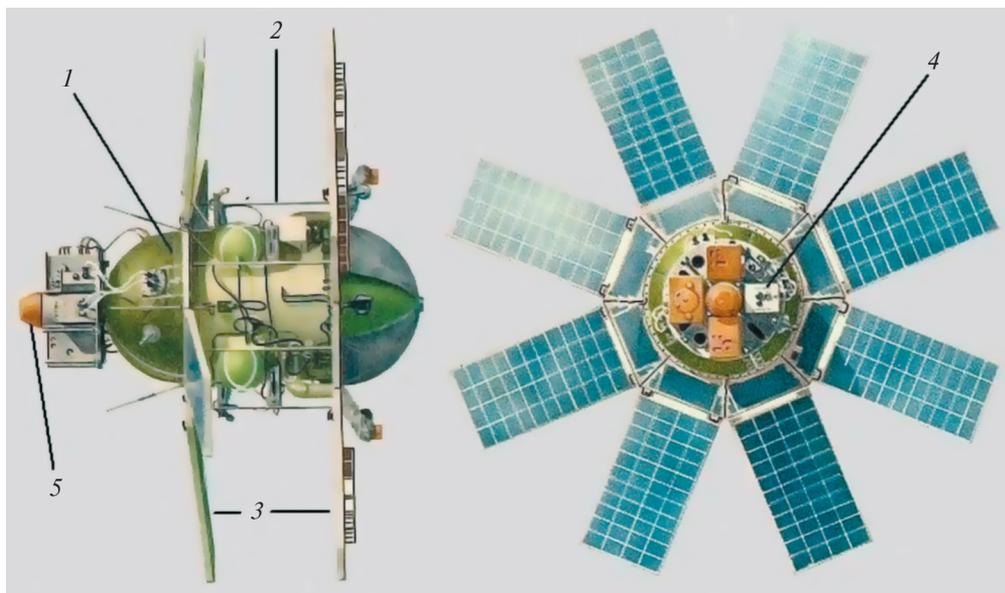
Схема ИСЗ серии "Космос" типа ДС-УЗ для исследования коротковолнового излучения Солнца: 1 – отсек под электронный блок научной аппаратуры, 2 – экранно-вакуумная термоизоляция, 3 – панели солнечных батарей, 4 – датчики научной аппаратуры, 5 – солнечный датчик системы ориентации
