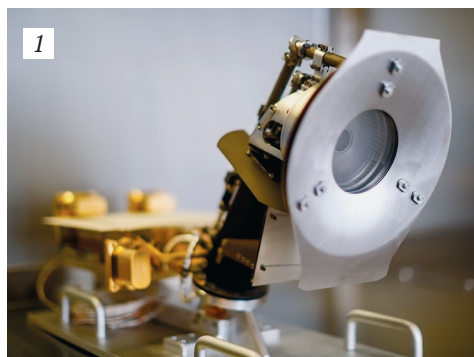
Приборы комплекса SWEAP: цилиндр Фарадея (1), анализаторы SPAN-a (2) и SPAN-b (3). Снимки сделаны в Гарвард-Смитсоновском Центре астрофизики
