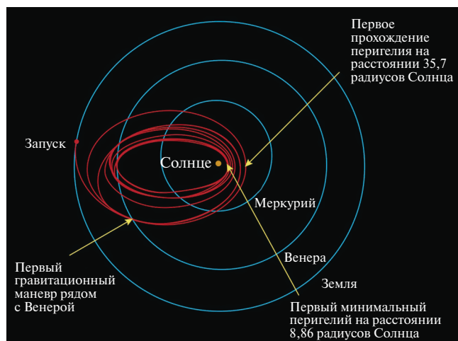
График движения космической солнечной обсерватории “Паркер” при планировавшемся ранее запуске, 31 июля 2018 г.; в действительности старт состоялся 12 августа. Вычисления выполнены в Лаборатории реактивного движения США. Рисунок NASA
