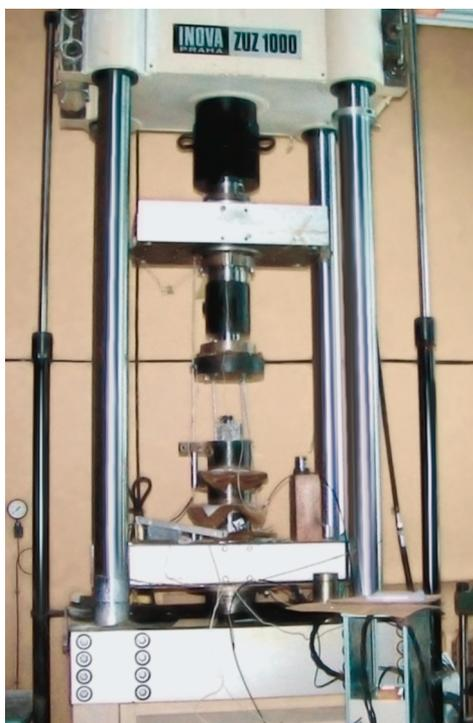
*Управляемый электрогидравлический пресс “INOVA” для экспериментальных исследований геодинамических процессов*
