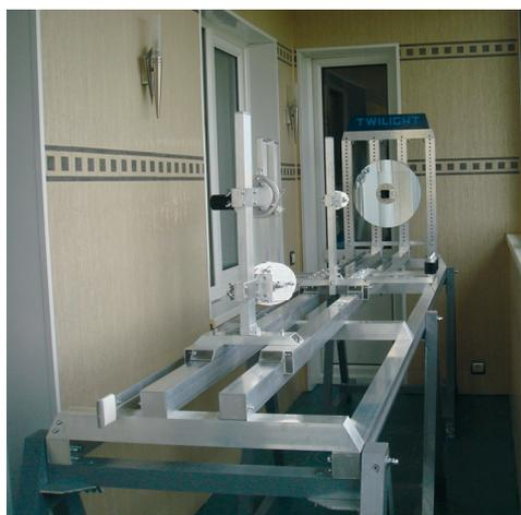
На рельсах скамьи стоят две стойки для вторичных зеркал
