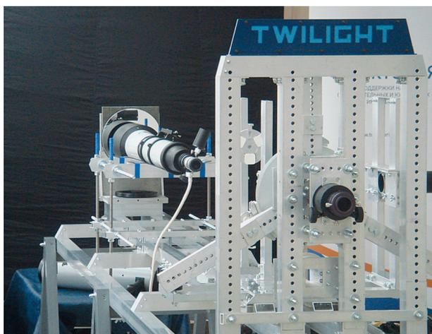
*Оптическая скамья с тестируемым телескопом*
