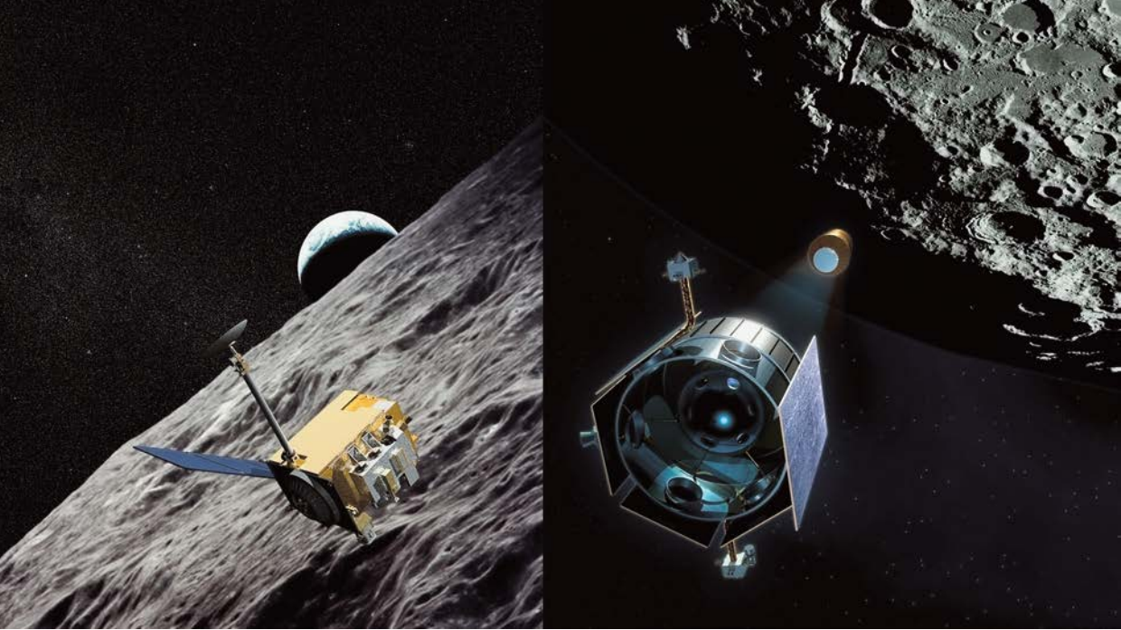
Космические аппараты “Лунный орбитальный разведчик” (слева) и “LCROSS” (справа), запущенные в июне 2009 г. с космодрома Канаверал с помощью РН “Атлас-5”. Лунный аппарат “LCROSS” 9 октября 2009 г. выполнил прямые измерения состава лунного вещества, которое было выброшено с поверхности лунного полярного кратера Кабеус при столкновении с ней разгонного блока “Центавр”. Рисунки NASA.
