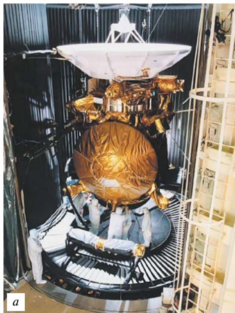
АМС «Кассини»: а – подготовка к запуску (вверху – основная радиоантенна, в центре – спускаемый аппарат «Гюйгенс»), б – старт 15 октября 1997 г. с помощью РН «Титан-4Б/Центавр» с космодрома ВВС США, Мыс Канаверал. Фото NASA.
