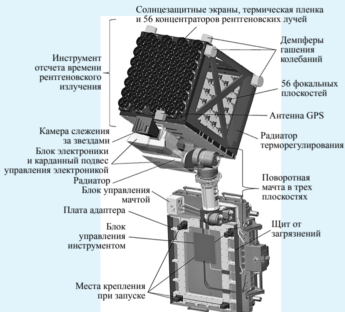
Схема прибора “NICER” с обозначением датчиков и бортовых систем. Рисунок NASA, GSFC.
