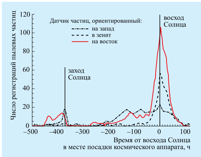
График регистрации пылевых частиц в трехчасовом интервале над поверхностью Луны прибором LEAM за период 22 лунных суток. Значительное увеличение скорости счета пылинок зарегистрировано за несколько часов до и после пересечения терминатора, особенно при восходе Солнца. По данным NASA.
