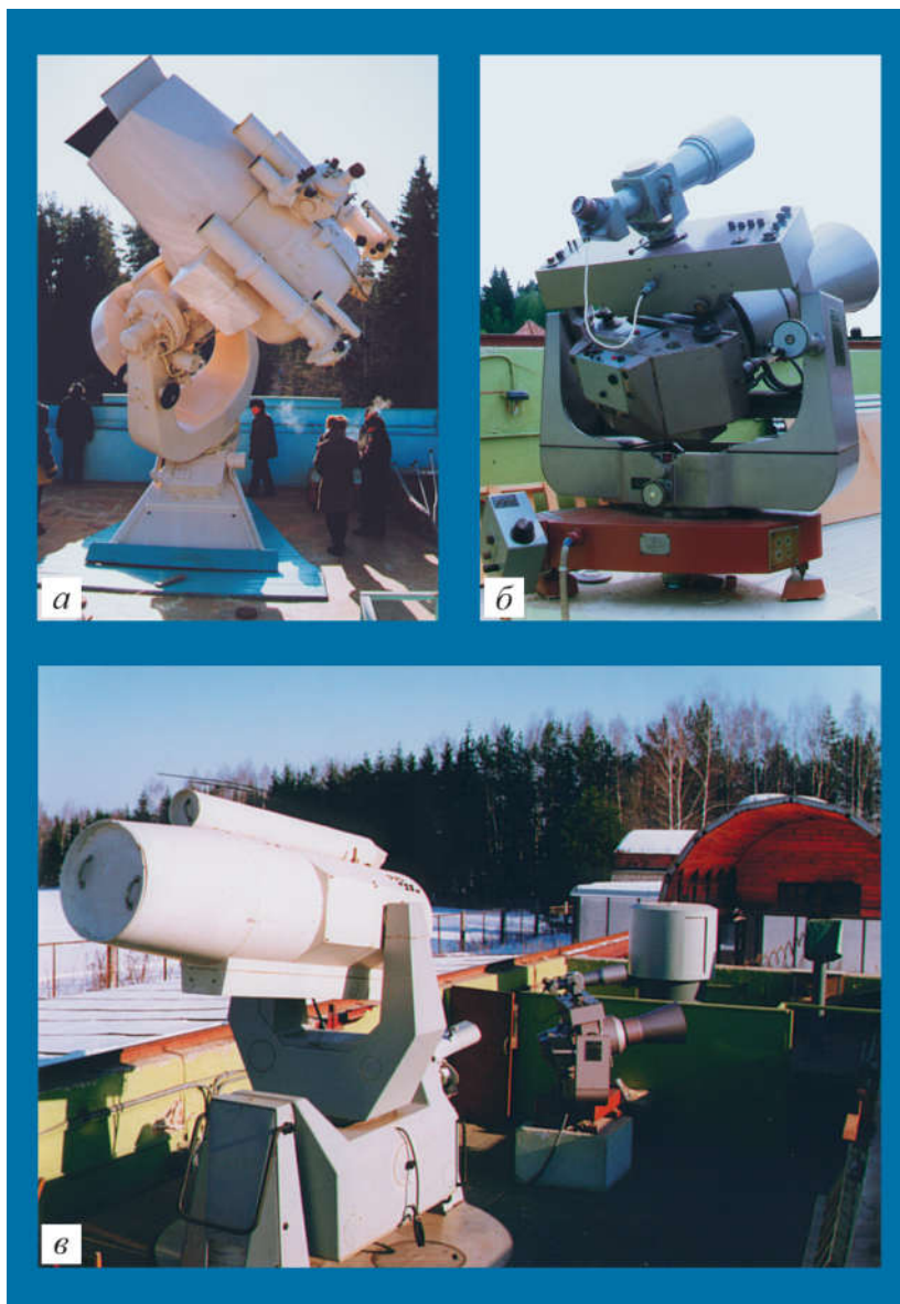
Астрономические инструменты ИНАСАН для наблюдения тел в околоземном космическом пространстве: а – высокоточная астрономическая установка ВАУ; б – астрономическая фотографическая установка АФУ-75; в – фотографическая камера SBG производства “Карл Цейс”.
