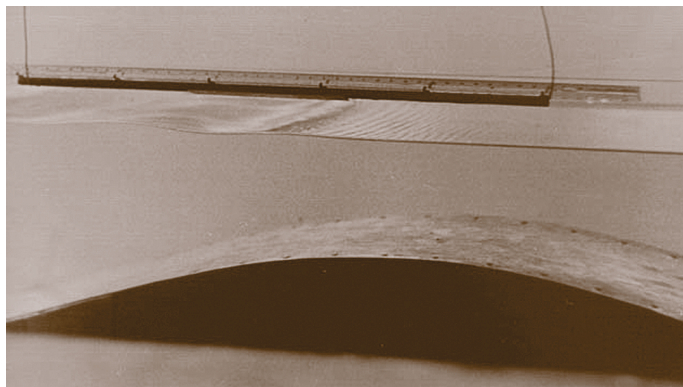
Волна, созданная волнопродуктором, распространяется слева направо навстречу течению вдоль лотка создания вдоль лотка создается специальным профилем дна. Наблюдается блокировка гравитационной волны. Лабораторный эксперимент.
