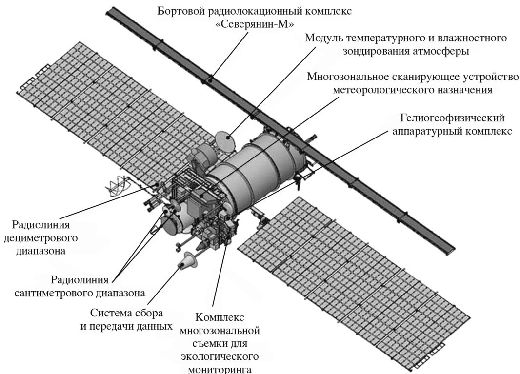
Расположение аппаратуры и систем на российском ИСЗ "Метеор-М" № 2. Рисунок Роскосмоса.
