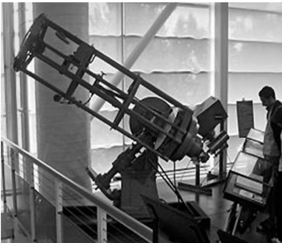
Первый телескоп Ричи – Кретьена ( D = 20 дюймов, или 0,5 м), построенный Дж. Ричи в Париже в 1927 г.
