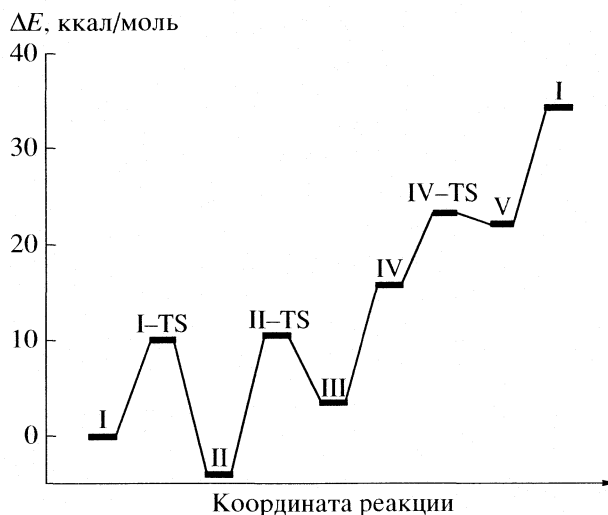
Рис. 5. Сечение поверхности потенциальной энергии дегидрирования этана на катализаторе Pt/GaZSM-5.
