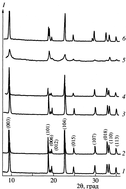
Рис. 1. Диффрактограммы исходных (1, 2) и обработанных (3–6) образцов \text{LiCoO}_2 (1, 3, 5) и \text{Li}_{1-x}\text{CoO}_2 (2, 4, 6); 3 и 4 – обработка водой, 5 и 6 – 1.0 н. раствором \text{H}_2\text{SO}_4 .
