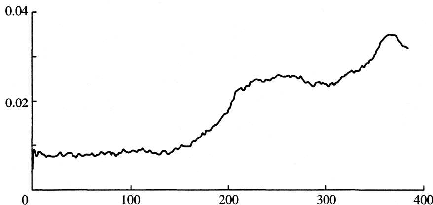
Рис. 3. Среднеквадратичное смещение атомов модели при 0.15T_{пл} в зависимости от числа шагов моделирования. Один шаг – 2 \times 10^{-13} с. Среднеквадратичное смещение приведено в единицах \sigma^2 .
