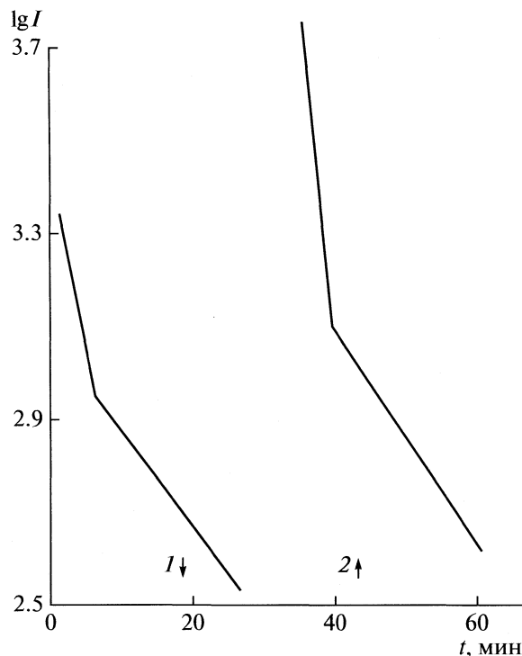
Рис. 1. Кинетика затухания ФСЭ с образца MgO, вакуумированного при 20°C. Стрелки ↓ и ↑ означают выключение и последующее включение УФО.
