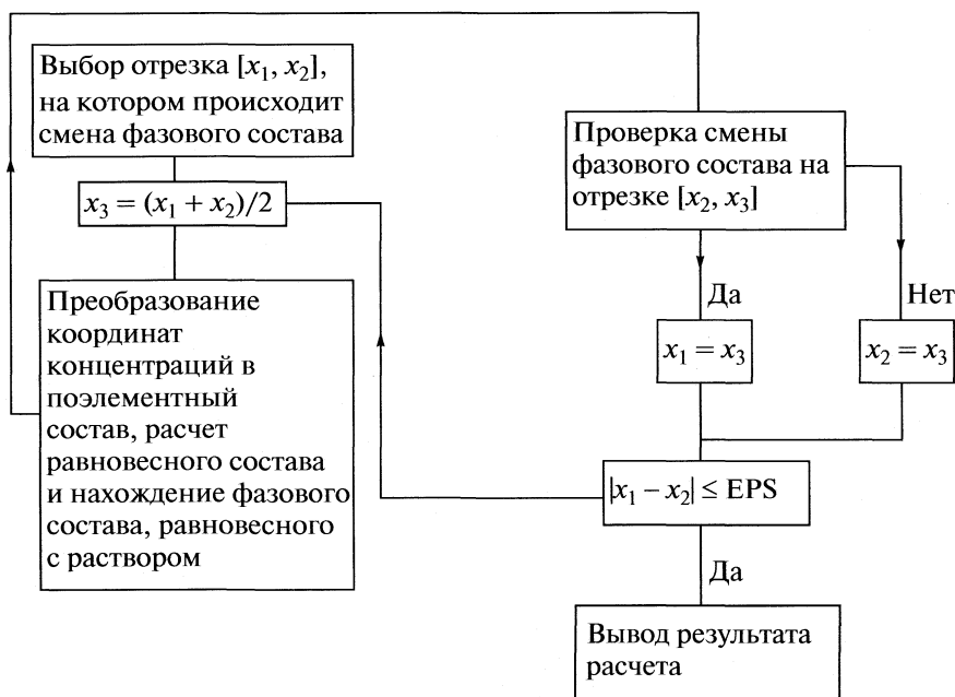
Рис. 3. Схема процедуры определения точки, соответствующей смене фазового состава системы, в координатах концентраций.
