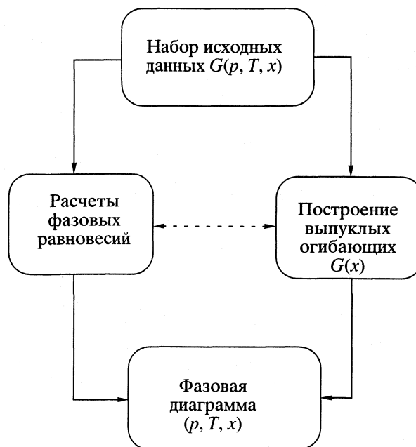
Рис. 1. Отличие предлагаемого способа термодинамического расчета фазовых диаграмм (на схеме справа) от традиционного. Пояснения даны в тексте.
