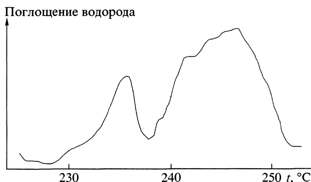
Рис. 1. ТПВ-профиль, полученный при восстановлении чистого NiO. Скорость нагрева 0.1 К/мин, масса образца 6 мг, расход смеси 30 см 3 /мин.
