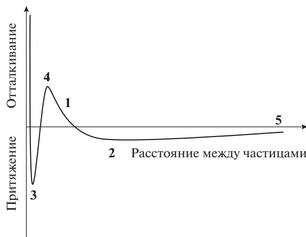
Рис. 2. Результирующая кривая энергетического взаимодействия в дисперсной системе (1); 2, 3 — дальний и ближний потенциальные минимумы; 4, 5 — ближний и дальний энергетические барьеры.
