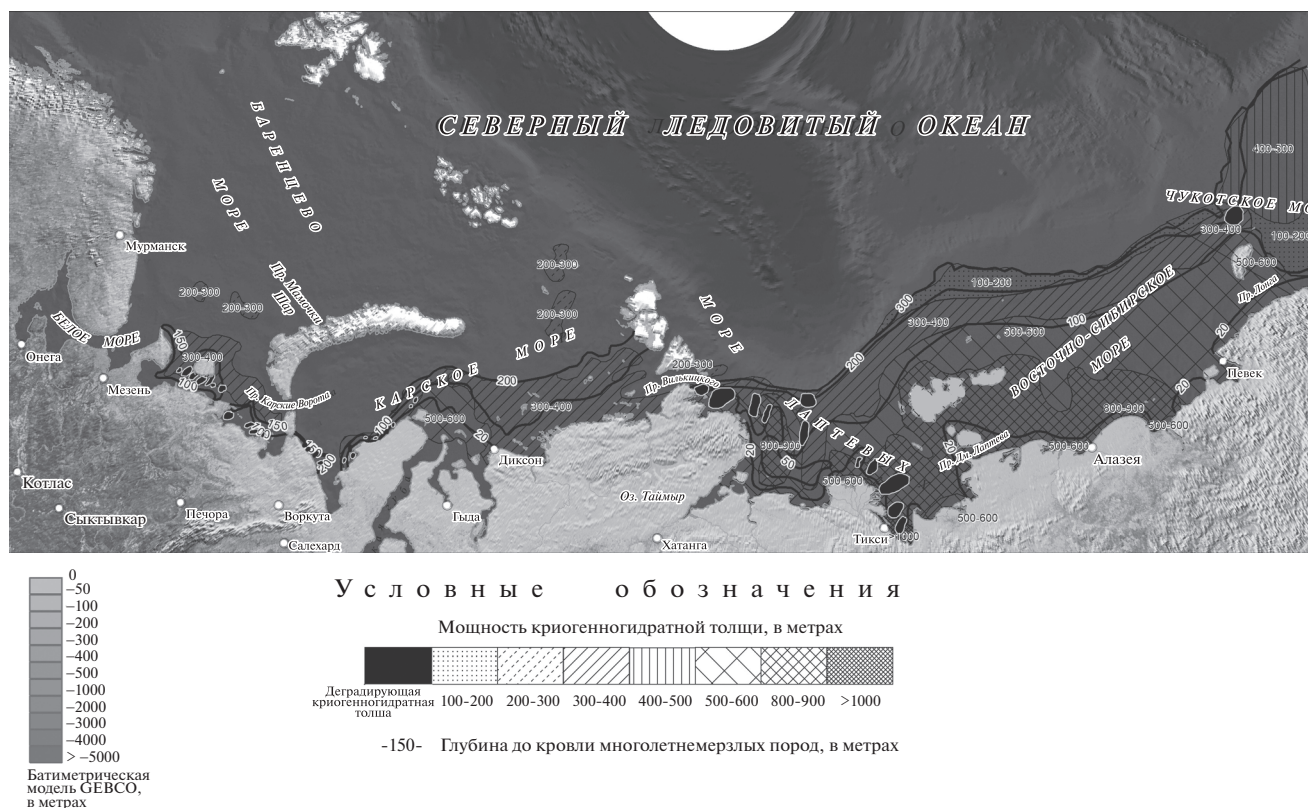
Рис. 5. Схема распространения криогенногидратных толщ на шельфе морей Российской Арктики.
