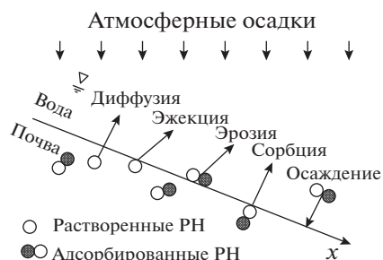
Рис. 1. Схематическое представление процессов массообмена между почвой и склоновым потоком воды.
