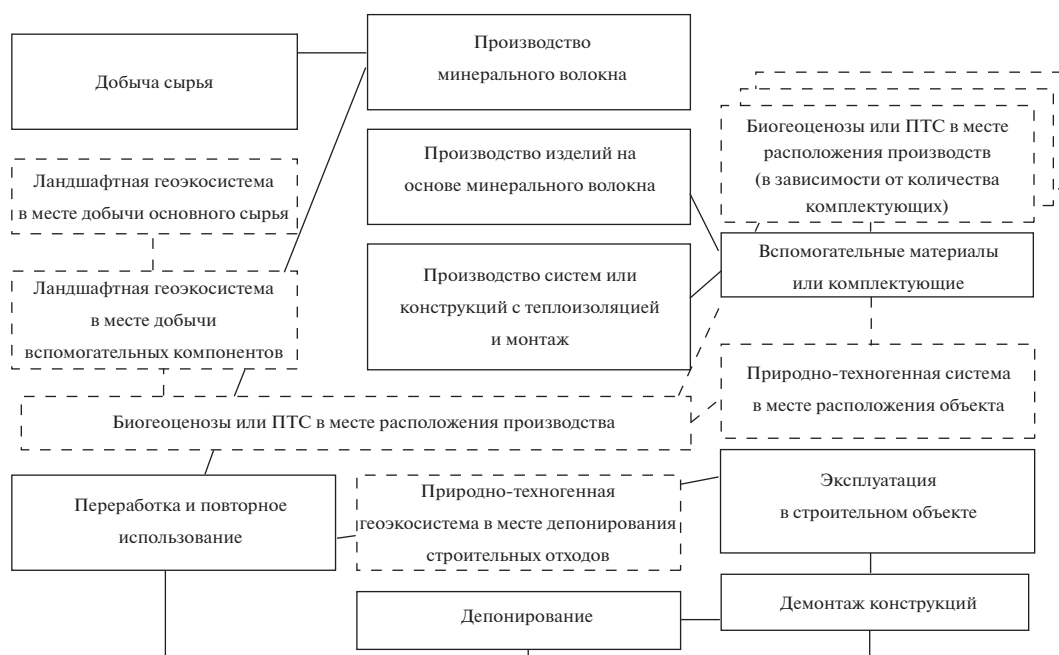
Рис. 1. Схема природно-техногенных систем по жизненному циклу на примере плит из минеральной ваты.
