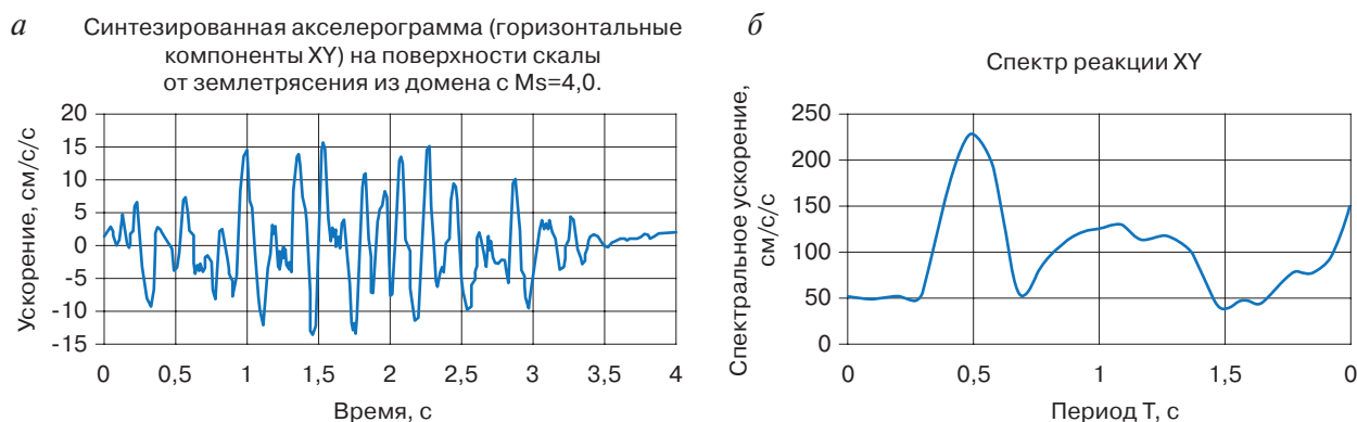
Рис. 5. Синтезированная акселерограмма (горизонтальные компоненты XY) на поверхности скального грунта от землетрясения из домена с M_s = 4.0 и R = 12 км (а), спектр реакции 5% (б).
